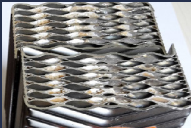
Тегло на теплообменника без MWD – 978g
